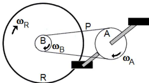
Na bicicleta, a coroa A conecta-se à catraca B através da corrente P. Por sua vez, B é ligada à roda traseira R, girando com ela quando o ciclista está pedalando.
