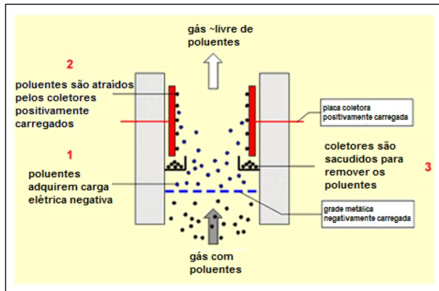
A fumaça poluída, ao passar pela grade metálica negativamente carregada, é ionizada e posteriormente atraída pelas placas coletoras positivamente carregadas. O ar emergente fica até 99% livre de poluentes. A filtragem do ar idealizada neste dispositivo é um processo fundamentalmente baseado na
